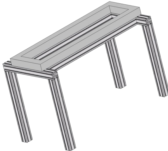
Abbildung 6-2: 3D-Modell eines Entwurfs mittels ITEM-Profilen.
