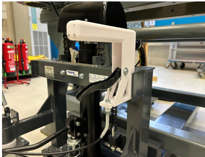
Abbildung 8-3: Neuer Griff am Hubwagen.
