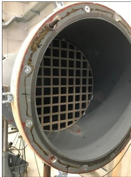
Abbildung 3.2.2: Eingebautes Gitter04 im Rohrprüfstand
