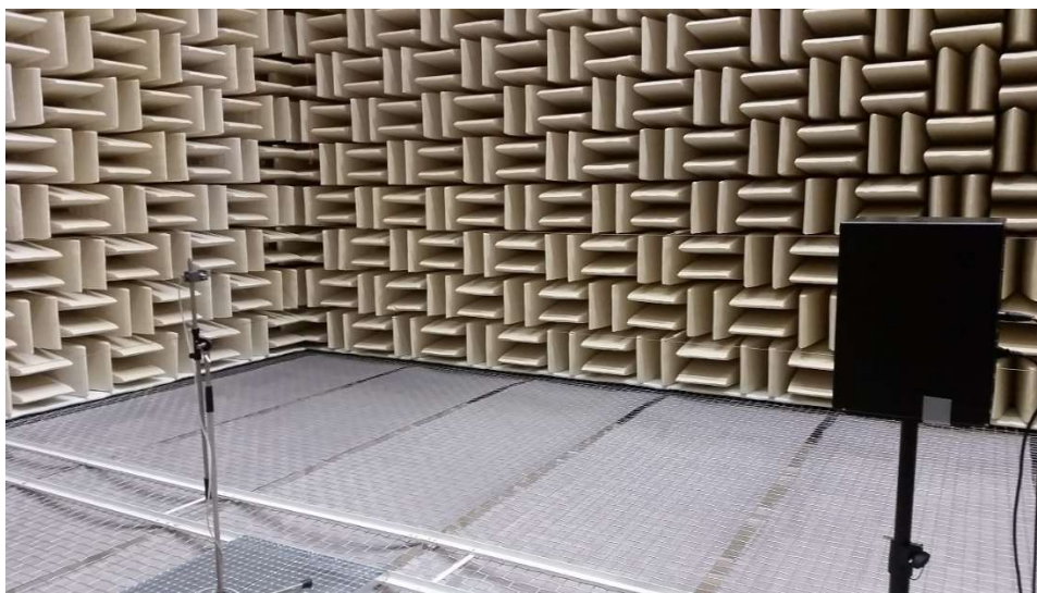
Abbildung 16: Reflexionsarmer Raum bei Messung des Frequenzgangs des Lautsprechers
