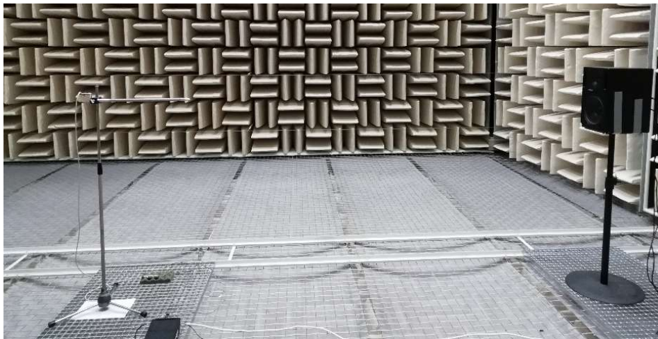
Abbildung 29: Messaufbau Ermittlung Frequenzgangkorrektur Schlitzrohrsonde im Abstand von 3,0 m
