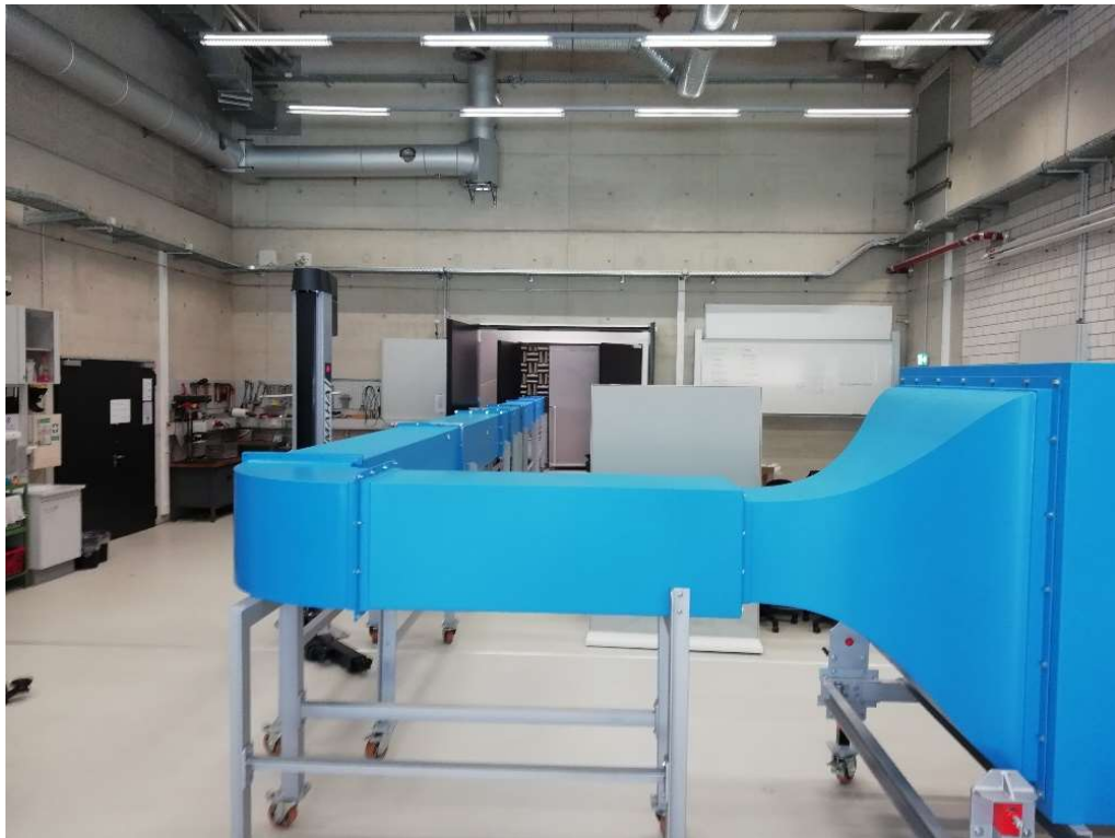
Abbildung 7: Verlängerung des Windkanals, im Hintergrund sichtbar ist der reflexionsarme Raum
