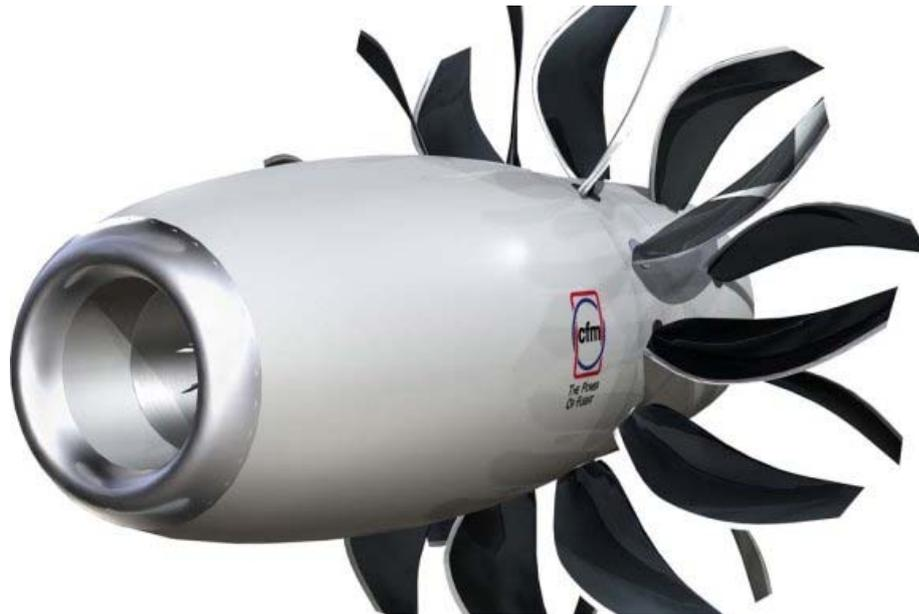
Abbildung 6: Kontrarotierende, offene Rotoren (CROR) (Flug, 2016).
