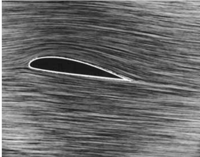
Abbildung 29: Tragflügel bei anliegender Strömung (Schlichting et al. 1967).
