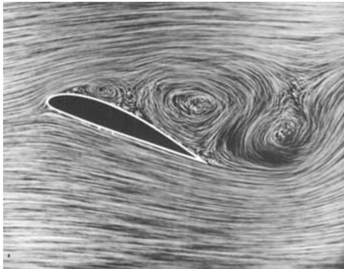
Abbildung 30: Tragflügel bei abgelöster Strömung, Strömungsabriss (Schlichting et al. 1967).
