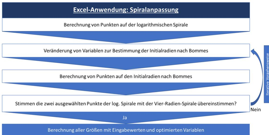
**Abbildung 4-3: Prinzip der automatischen Anpassung der Vier-Radien-Spirale nach der Excel-Anwendung**
