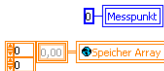
Bild 33: die Variablen „Messpunkt“ und „Speicher Array“ werden zu Null gesetzt
