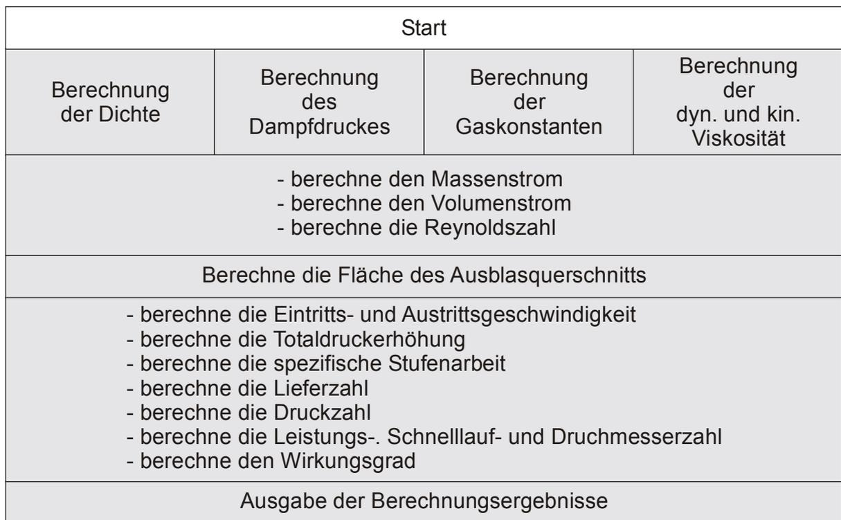
**Bild 53:** Struktogramm für die Berechnung beim saugseitigen Prüfstand
