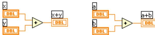
**Bild 8:** Parallele Strukturen in einem LabVIEW Diagramm
