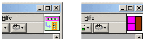
Bild 15: VI-Symbol und Anzeige der Anschlüsse des VIs
