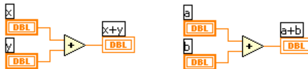
Bild 8: Parallele Strukturen in einem LabVIEW Diagramm
