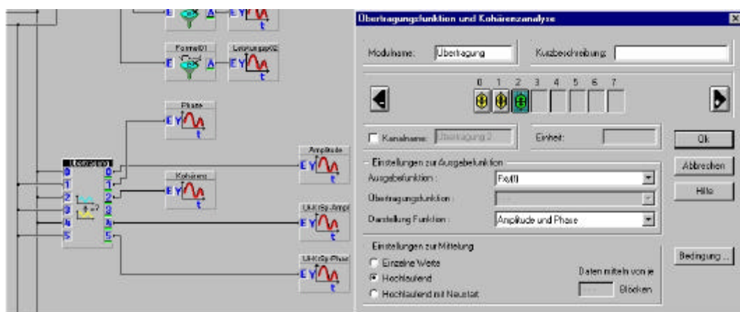
Abb. 3.13 Ausgabe von Phase und Amplitude über das Kreuzleistungsspektrum
