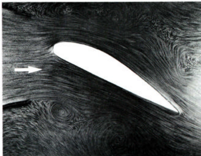
Bild 4.6.2 Tragflügel in Strömung
