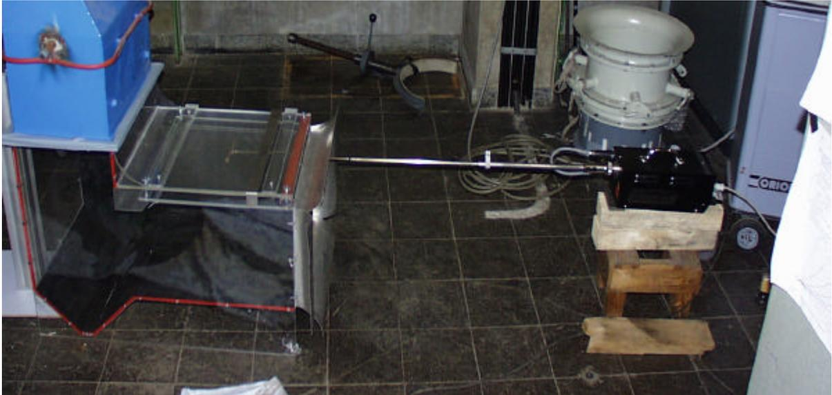
**Bild 6.1.2.3:** *Nebelgerät mit Lanze am Modell*
