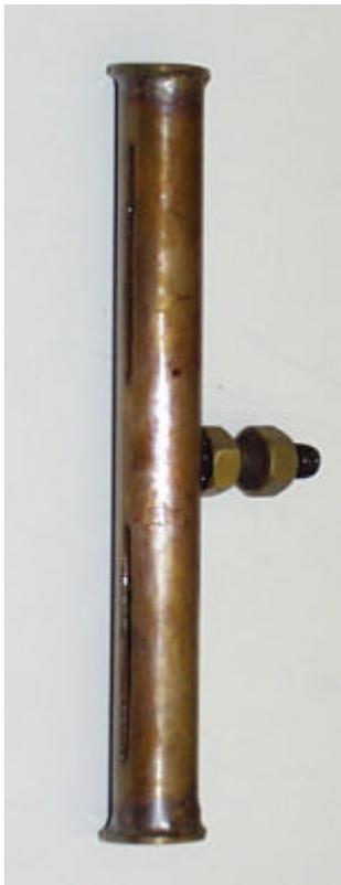
An dieses Gerät wird eine Heizlanze angebracht, über die der Nebel in das Modell strömt (**Bild 6.1.2.3**). Am Austrittsende dieser Lanze befindet sich eine spezielle Auslaßdüse (**Bild 6.1.2.2**), über die der Nebel an der gewünschten Stelle flächig verbreitet wird. Damit das Nebelfluid in der Lanze nicht kondensiert, befindet sich in ihr ein Heizdraht.
