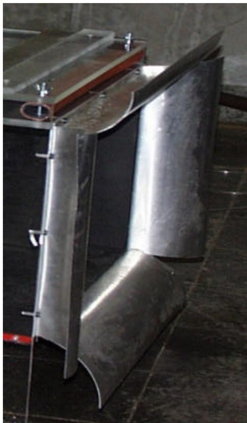
Zur Vergleichmäßigung der Eintrittsströmung sind am Kanaleintritt abgerundete Einlaufbleche gemäß einer Viertelkreis-Einlaufdüse aus Aluminium (**Bild 4.6**) angebracht. Mit Hilfe dieser Bleche legt sich die in den Kanal eintretende Strömung direkt an die Kanalwände an. Bei ersten Vorversuchen ohne die Bleche war die Strömung im Kanalmodell stark gestört, so dass noch keine Ähnlichkeit zu einer Strömung im Rauchgaskanal erkennbar war.
