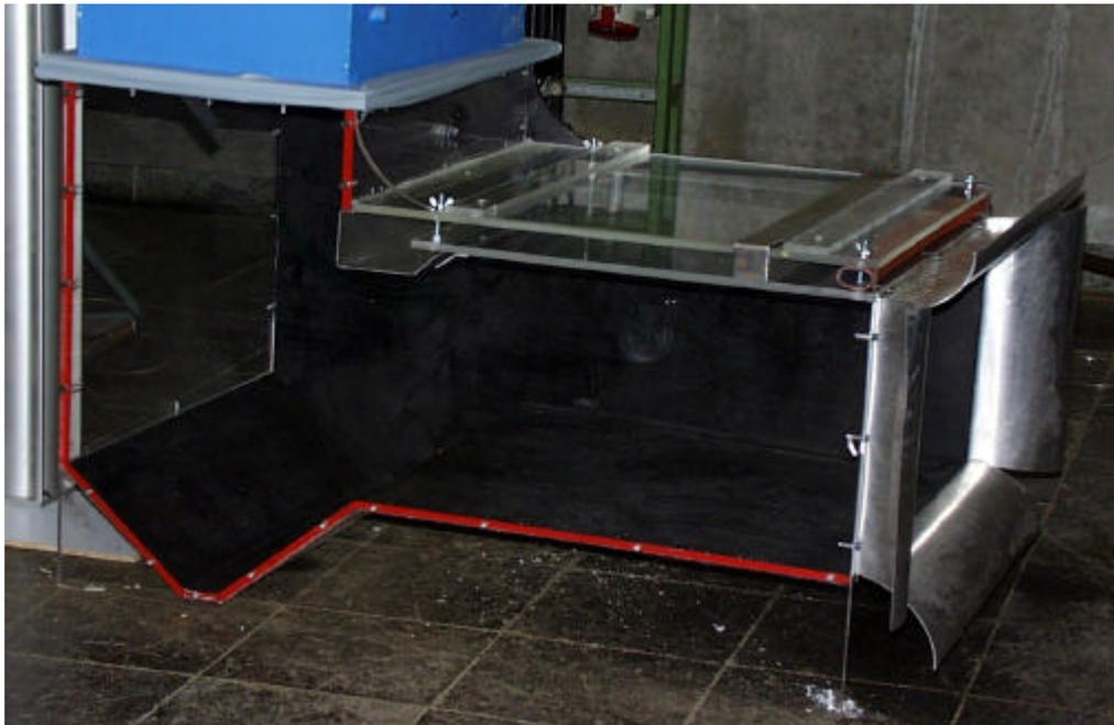
**Bild 4.2:** Das Modell; bestehend aus 10mm Acrylglasplatten und 9mm Multiplex-Holzplatten (schwarz)
