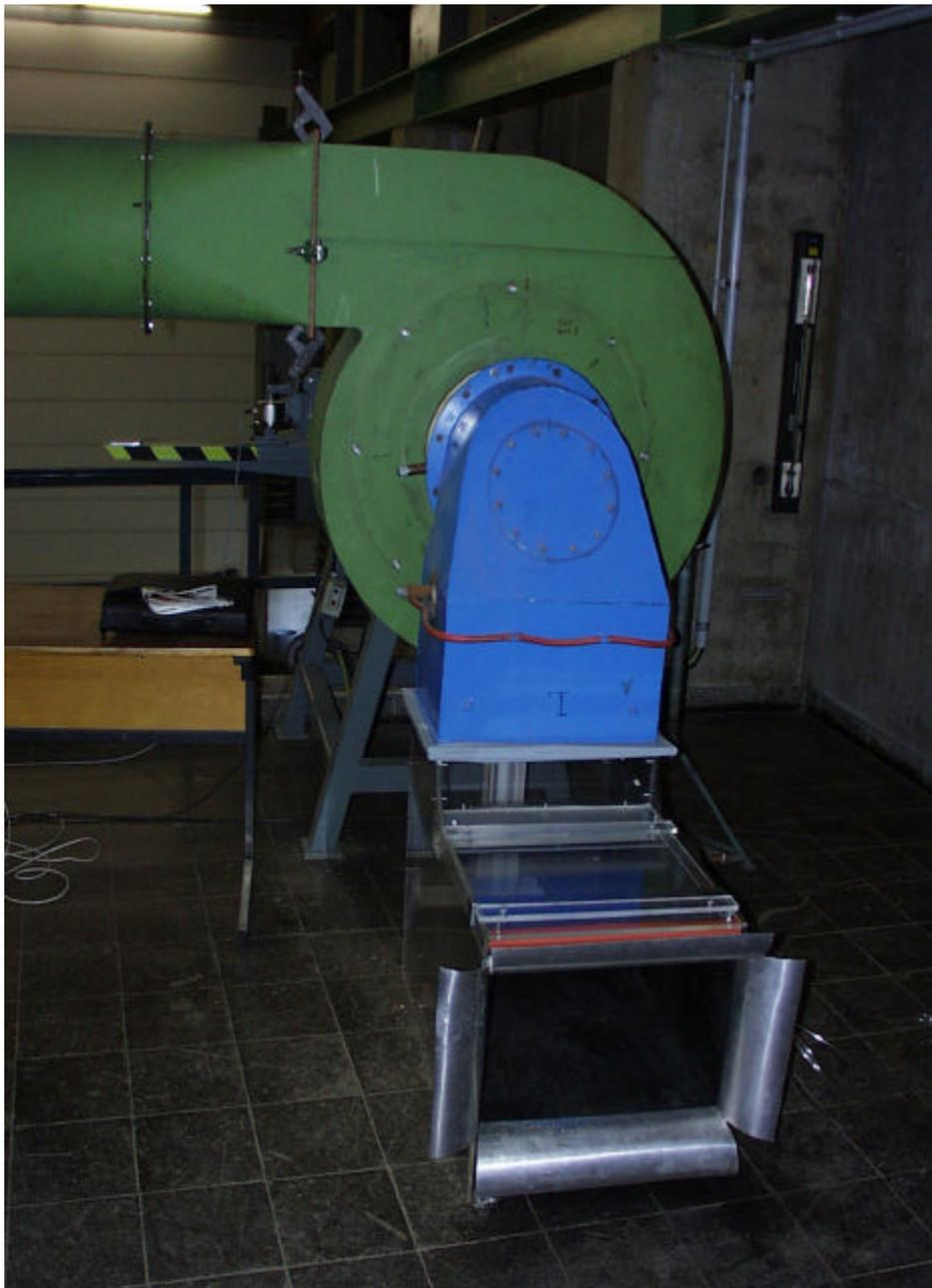
**Bild 5.1:** Versuchsstand mit Radialventilator und Modell
