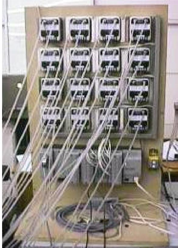
**Bild 6.2.1.2:** Druckmessdosen und Datenerfassungssystem DA 100
