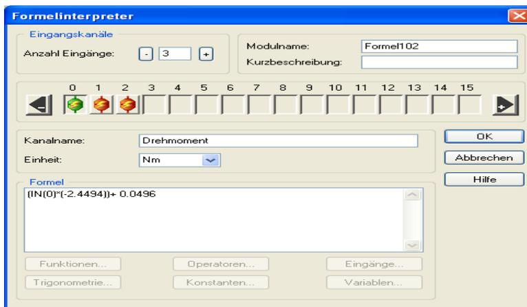
Bild 68: Drehmoment bei der Empfindlichkeit 0,5 mV/V
