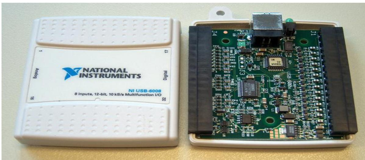
Bild 34: Datenerfassungssystem NI USB-6008 /12
