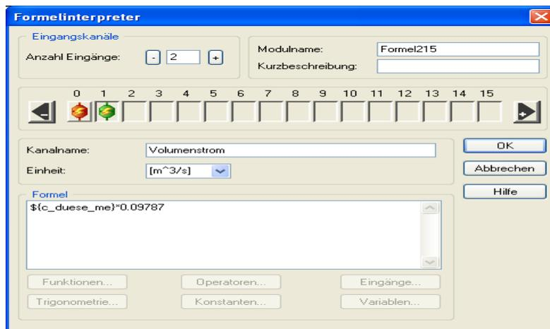
Bild 104: Formel zur Berechnung des Volumenstrom an der Düse
