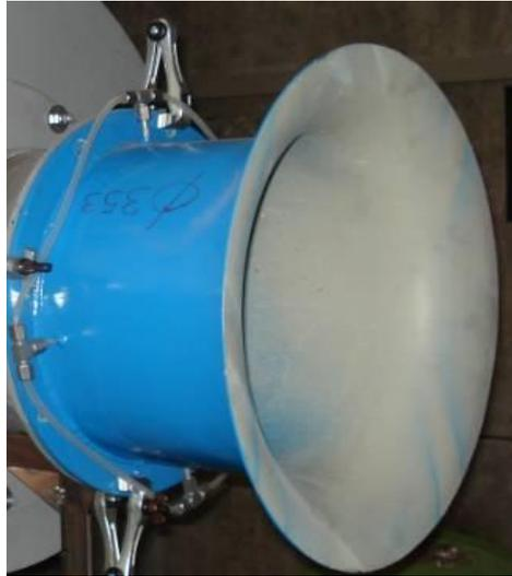
Bild 19: Die verwendete Viertelkreisdüse
