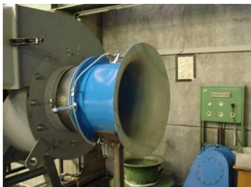
Bild 14: Einlaufdüse DN350 mit überdecktem Spalt
