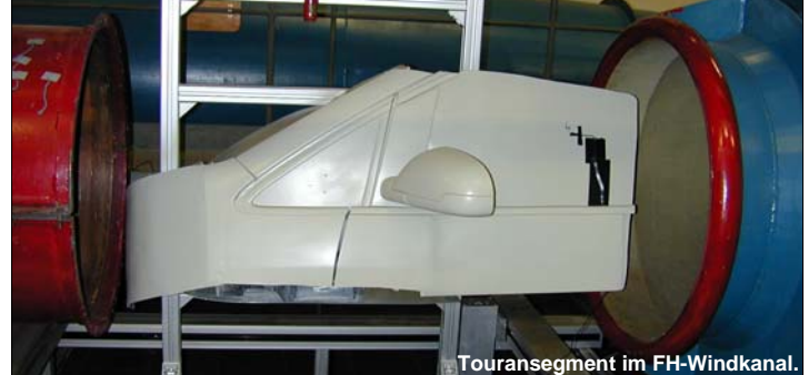
Angebrachte Turbulatoren an einen VW Touran Außenspiegel (2005).
