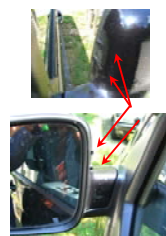
Abbildung 4: Turbulenzerzeuger zur Reduktion tonaler Geräuschkomponenten. [4] [5]
