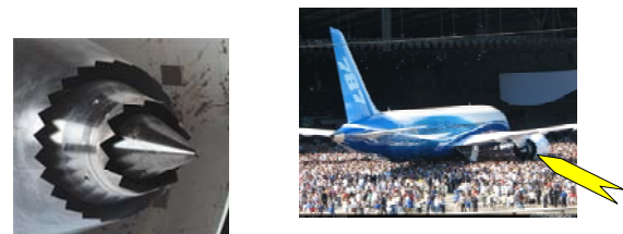
Chevron Nozzle an einer CF-34 Engine, ASME 2006. Michel, DLR (2003): 1-3 dB bei 1% Treibstoffmehrerbrauch. http://www.memagazine.org/nov06/features/nozzle/nozzle.html
