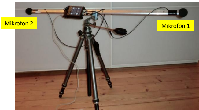
Abbildung 2: Zwei-Mikrofon-Array aus ¼“ICP-Mikrofonen und ROGA-USB Soundkarte.
