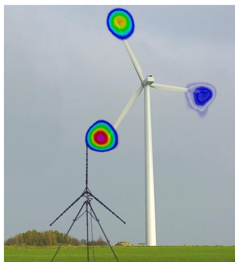
Abbildung 9: Quellenlokalisierung mit einem Mikrofonarray (Akustische Kamera) – Quellen an der Blattspitze. https://www.gfaitech.com/applications/wind-turbine
