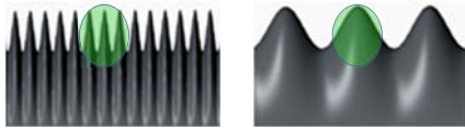
Abbildung 12: Unterschiedliche Wellenlänge der Serration A14λ4 (links) und der Serration A14λ22 (rechts), zur Verdeutlichung des besseren Druckaufbaus bei großer Wellenlänge.
