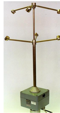
Bild 2: Ultraschallanemometer, Firma METEK [9].
