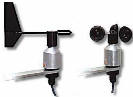
Bild 1: Schalenkreuzanemometer und Windfahne [2].
