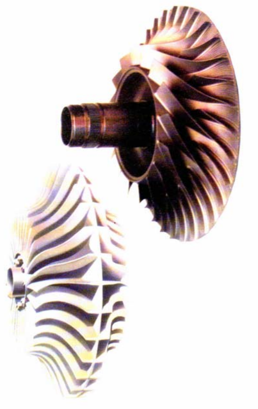
Bild 1.11: Radialer Hochdruckverdichter, Rolls-Royce plc., 1992.
