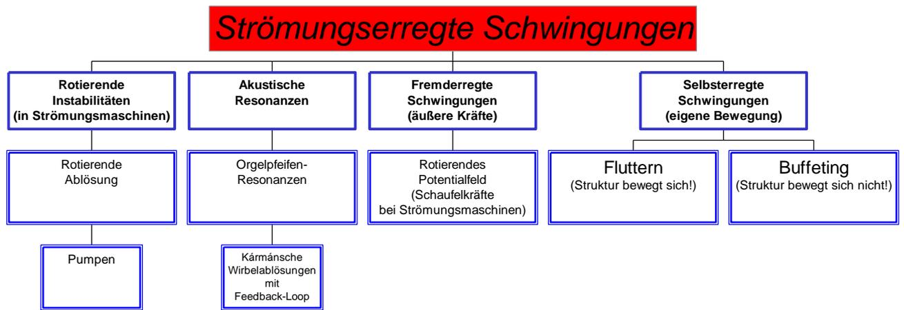
**Bild 4.18:** Zusammenfassung strömungserregter Schwingungen.
