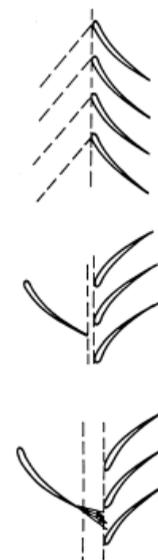
**Bild 3.9:** Rotor- Stator Wechselwirkung.
